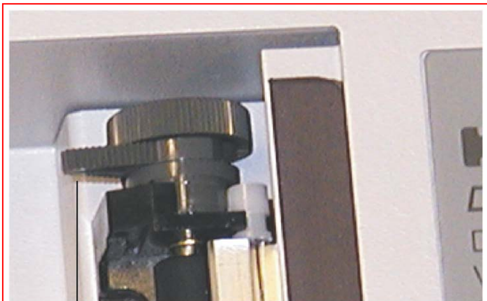
Hebel, um Thermo-Druckkopf anzuheben oder abzusenken (Illustration: Thermo-Druckkopf abgesenkt)
