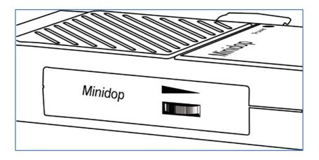
Hier befindet sich der Lautstärkeregler. Stellen Sie ihn nach dem Einschalten des Gerätes zunächst auf Mittelstellung und richten Sie die Lautstärke später für sich optimal ein.
