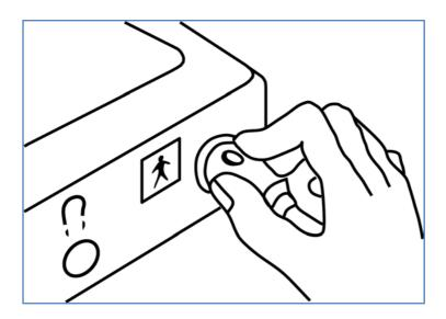
Stecken Sie den Sondenstecker vorsichtig so in die Sondenbuchse, dass die Markierung auf der Stecker-Ummantelung nach oben zeigt.
