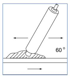
Setzen Sie die Sonde leicht mit einer Neigung von etwa 60° zum Gefäß in oder gegen Blutflussrichtung auf die zu untersuchende Stelle. Bewegen Sie die Sonde, ohne Druck auszuüben, um den idealen Anstellwinkel zu finden, bei dem das Doppler-Geräusch am stärksten und deutlichsten zu hören ist.
