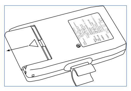
Öffnen Sie das Batteriefach, indem Sie mit leichtem Druck auf die Deckelmarkierung drücken und gleichzeitig den Batteriefachdeckel in Pfeilrichtung aus dem Gehäuse ziehen.
