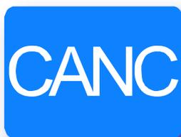
Drücken Sie diese Taste, um Eingaben innerhalb einer Zeile zu schrittweise löschen. Stellen Sie vorab den Schreib-Cursor rechts neben zu löschenden Zeichen.
