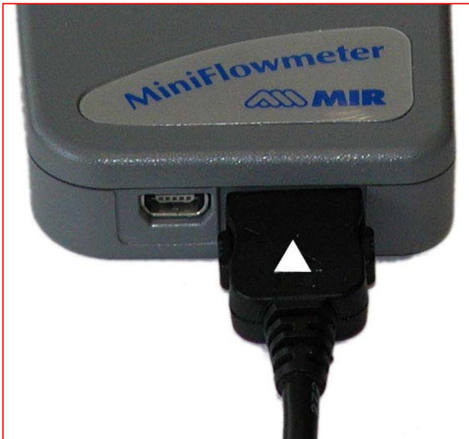
**Achtung:** Wenn Sie das Kabel vom MiniFlowMeter entfernen wollen, halten Sie die beiden seitlichen Entriegelungs-Tasten gedrückt und ziehen den Stecker vorsichtig aus der Buchse.
