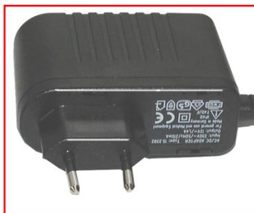
Links: Netz-/Ladeteil mit aufgedrucktem Typenschild.
