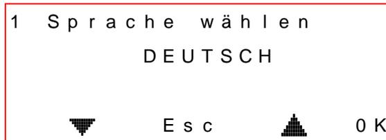
Mit den ▼ oder ▲ Tasten bewegen Sie sich durch alle integrierten Sprachen. In der zweiten Zeile des Displays wird jeweils die Sprache angezeigt. Ihre Auswahl bestätigen Sie, indem Sie die Taste **On/Enter** drücken.
